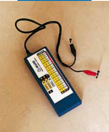
Mapecem şap içindeki nem seviyesini ölçmek için elektronik higrometre
