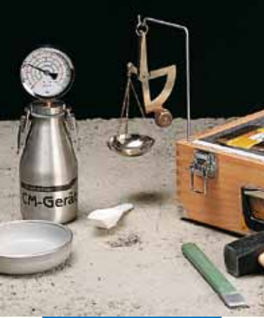
Mapecem şap içindeki nem seviyesini ölçmek için karbür higrometre
