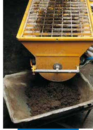
Mapecem'in mini harç makinesinde karıştırılması
