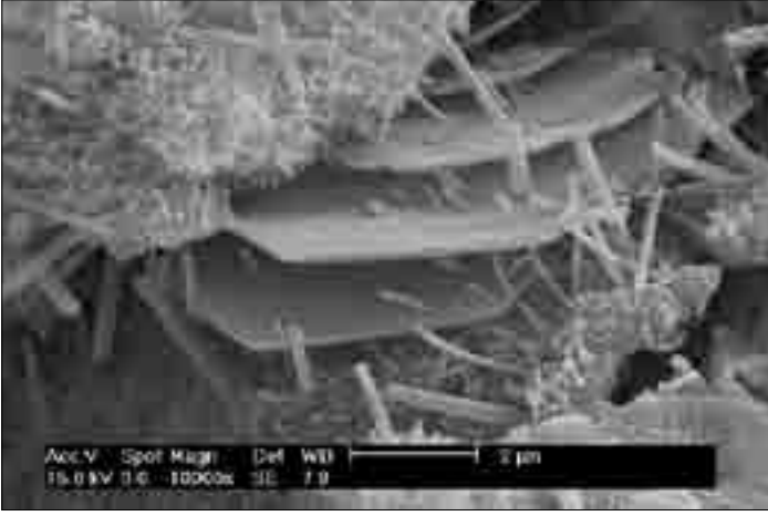
Geleneksel bir derz dolgusunda Portland çimentosu esaslı bağlayıcının hidratasyonu
