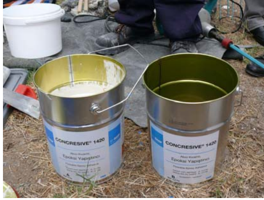
Şekil 8. Concrese® 1420 malzemesinin karışım öncesi karıştırma oranlarına göre tartılarak ölçülmesi
