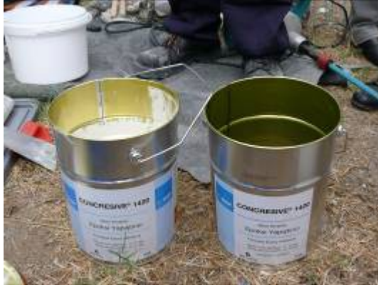
Şekil 6. Concresive® 1420 malzemesinin karışım öncesi karıştırma oranlarına göre tartılarak ölçülmesi
